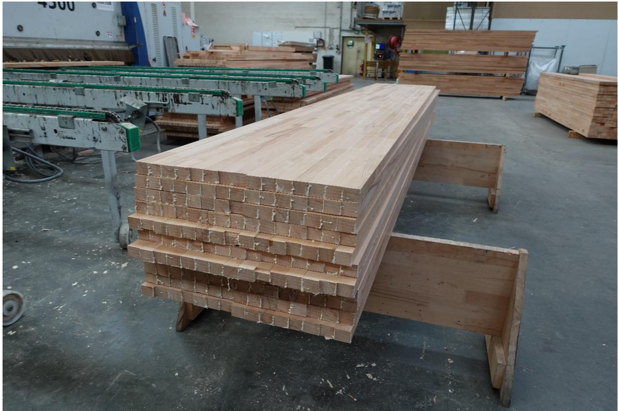
Un poteau lamellé-collé en hêtre, en cours de fabrication aux Grandes-Ventes
